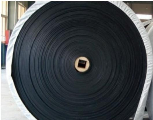
**КОНВЕЙЕРНЫЕ (ТРАНСПОРТЕРНЫЕ) ЛЕНТЫ** изготавливаются шириной от 400 до 2000 мм на основе синтетических полиэфирных тканей типа ЕР-200, ЕР-300, ТК-200 разрывной прочностью в продольном направлении 100, 125, 160, 200, 250, 315, 400, 500 Н/мм с количеством прокладок в каркасе от 2 до 6, с резиновой двухсторонней обкладкой 2-12 мм и резиновыми бортами.
