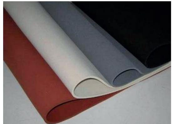
Пищевая резина (ГОСТ 17133-83) - вулканизированные резиновые пластины, предназначенные для изготовления уплотнителей неподвижных соединений и других изделий, контактирующих с различными пищевыми продуктами при давлении до 0,6МПа и температуре от -30°C до +130°C. Пищевая пластина белого цвета поставляется в виде формовых пластин размерами 500\*500мм и 700\*700 мм , а также черного и бежевого цвета в виде неформовых рулона.
