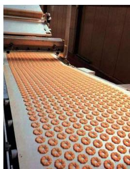
И немного в стороне от других пищевых лент стоят ленты из **ПОЛИУРЕТАНА С СИЛИКОНОВЫМ ПОКРЫТИЕМ** для предотвращения всякого типа скольжений. Эксплуатационная температура такой ленты варьируется от -10 до + 80°C. Чаще всего полиуретановые ленты с силиконовым покрытием применяют в производстве пищевых материалов, которые обладают повышенной липкостью.
